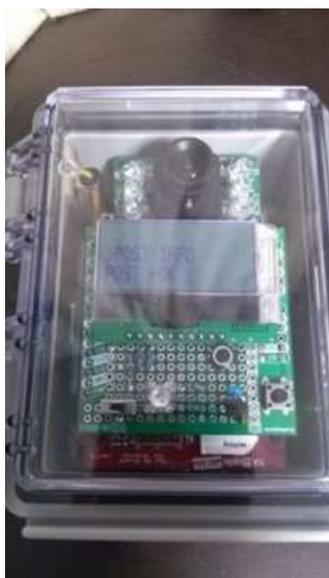
図 5. 2013 年春開発された農業用モニタリングシステム
