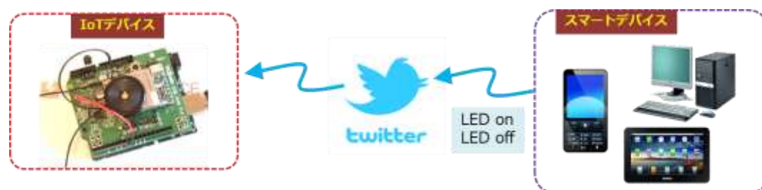
図2. 事例2：スマホからツイートしIoTデバイスを制御する方法
