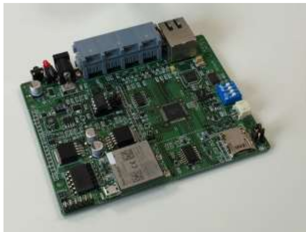
図 1 7．工場内監視モニタリング汎用デバイスボード
