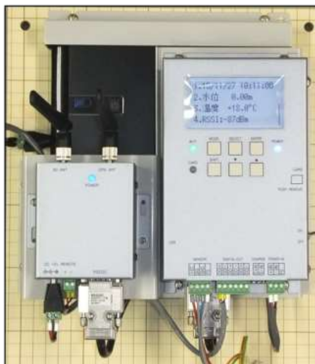
図8. 3 GIM を使った水位計測システム実用品
