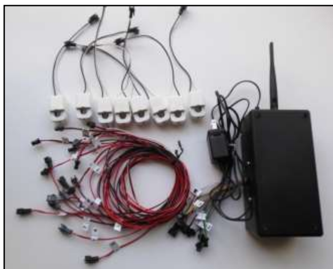
図 10. 3 G シールドを使った太陽光パネル発電量計測システム実用品
