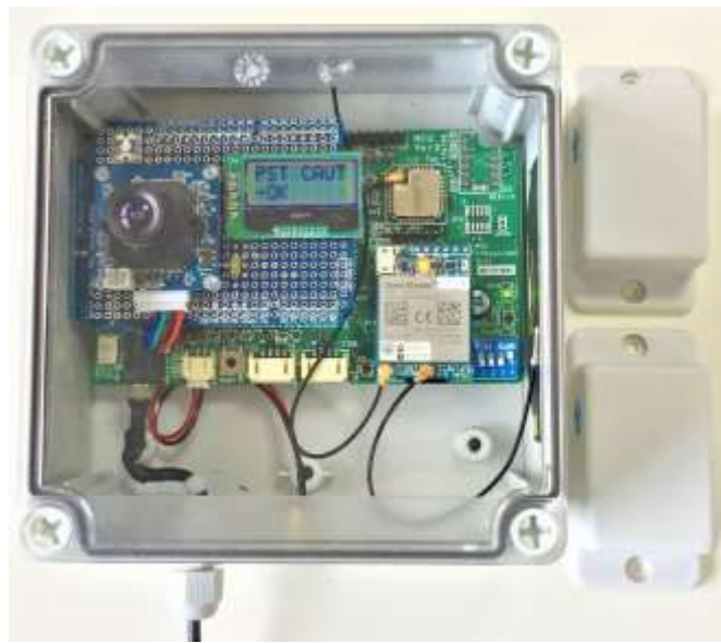
図 2 0. 遠隔防災監視システム（左：親機、右：子機）
