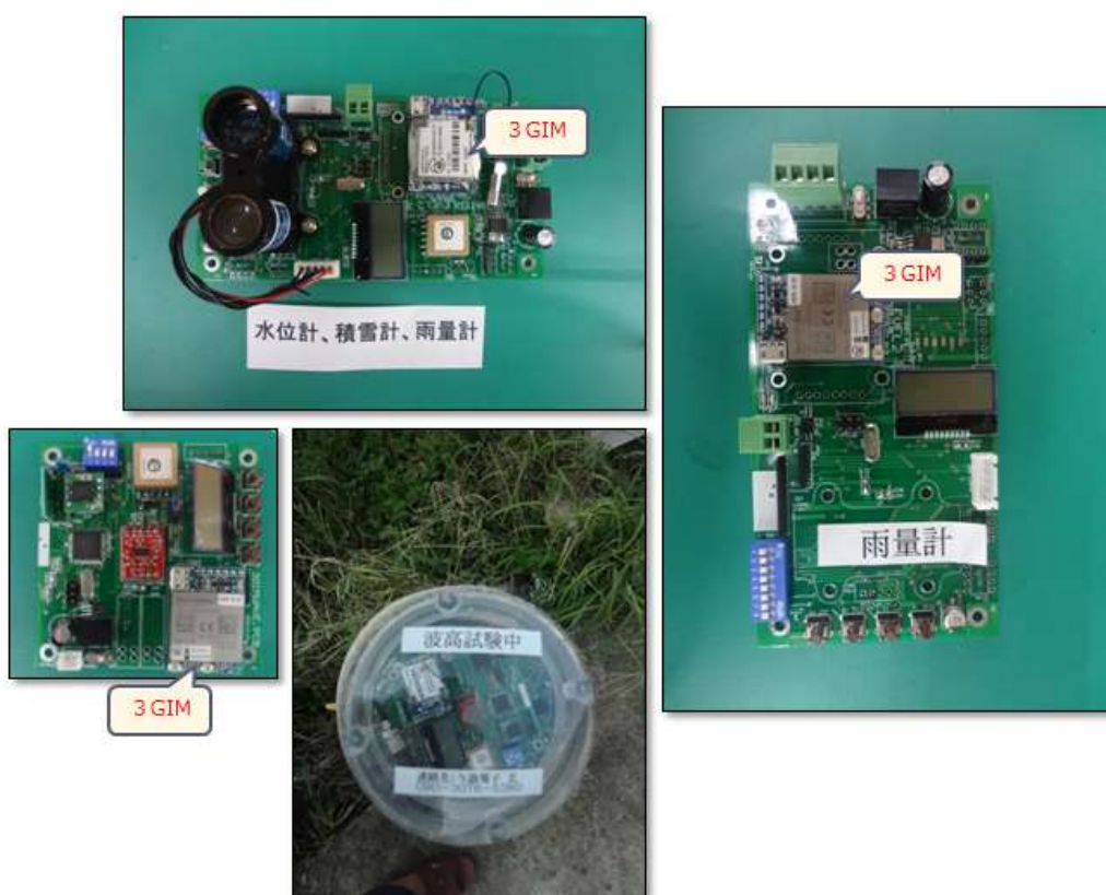
図 9. 3 GIM を使った気象観測（雨量計測）システム実用品
