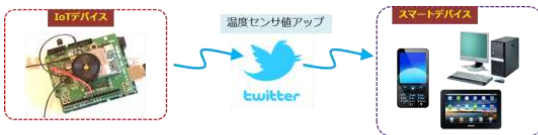
図1. 事例1：温度センサ値をツイートする方法
