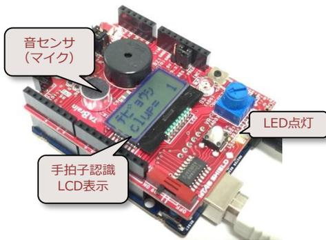
手拍子の数を認識して、その数をLCD・LEDに表示。赤外線リモコンと組み合わせ家電の制御などに利用可能。
