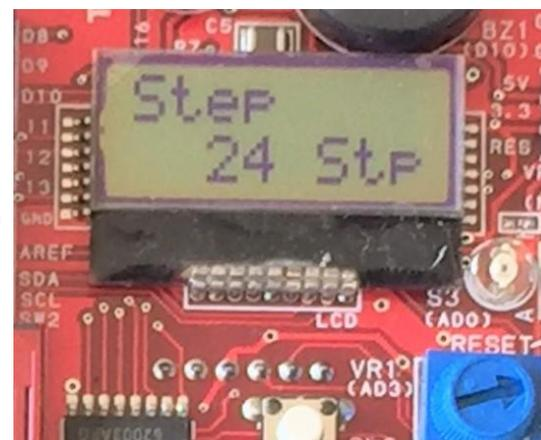
Genuino101上に搭載された3軸加速度センサを使って万歩計サンプルプログラムを利用して、IoTABシールド上のLEDとLCDを活用するように変更します。
