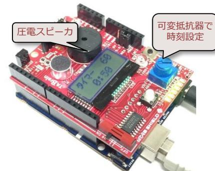
可変抵抗器、タクトスイッチ、LCD、LED、スピーカ、それに時間関数を使って実現
