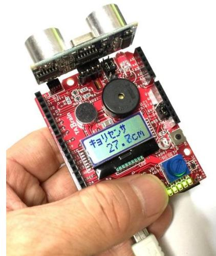
IoTABシールド V4.0は、全12個の電子部品を搭載し、オープンソースハードウェアの業界標準（デファクトスタンダード）であるArduino UNO R3やGenuino101上で、誰もが簡単に短時間にセンサ類やLED・LCDなどが活用できるようにした教材キットです。
