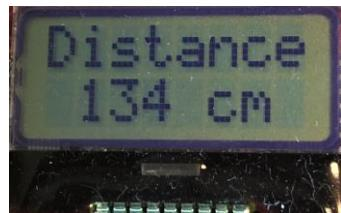
超音波距離センサ稼働時
