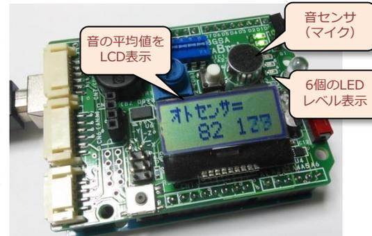
音センサの値をLCDに表示。同時に6個のLEDを使ってレベル表示。ある間隔の平均音量も並列して表示。
