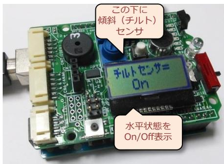
チルトセンサにより、電源のON/OFFを組み込む。
