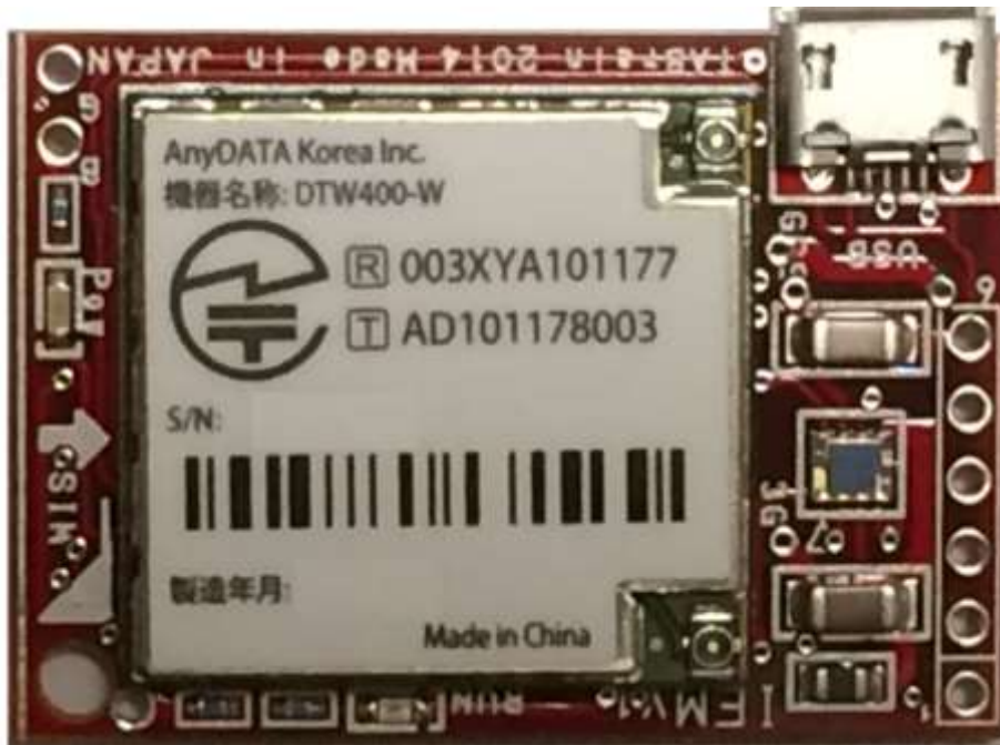
【参考資料1：写真1】 3Gブレイクアウトボード（表裏写真） <寸法は、35mm×25mm>
