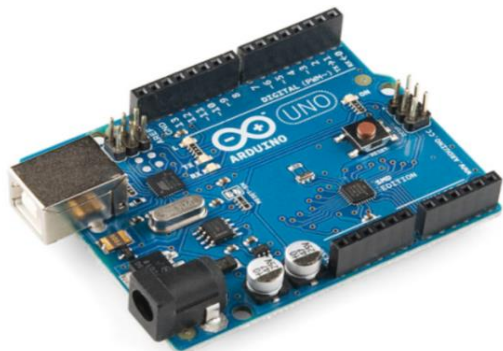
Atmel AVR (UNO R3 は 8ビットマイコン)
