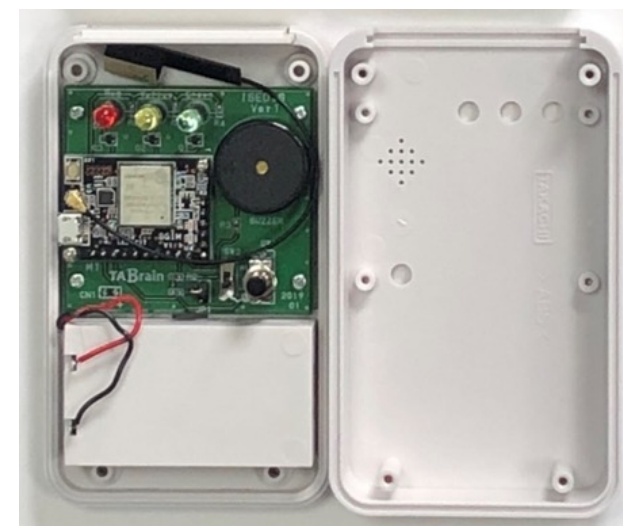
地震動モニタリングIoTデバイス（量産品）
