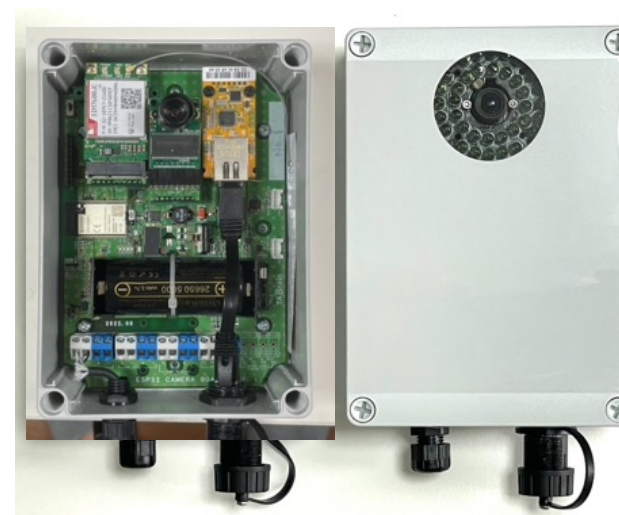
開発したIPカメラ制御用の納品物（IPカメラは、LANケーブルで接続） 電源は1 2Vを利用で、外部にソーラーパネルなどを搭載して利用
