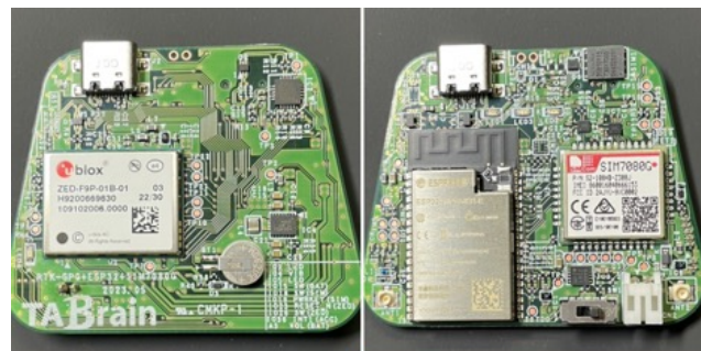
新たに回路設計から基板設計まで対応したRTK-GPSデバイス
