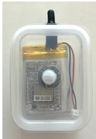
人感センサ検知IoTデバイス（簡易版）25セット開発
