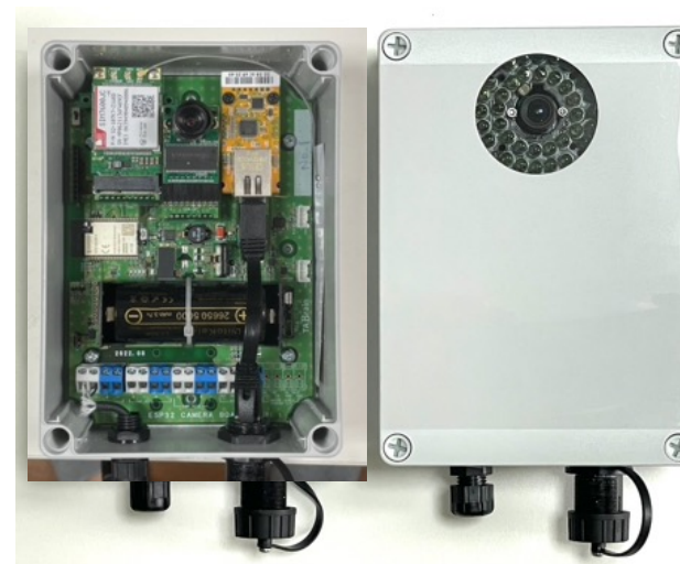
開発したIPカメラ制御用の納品物（IPカメラは、LANケーブルで接続） 電源は1 2 Vを利用して、外部にソーラーパネルなどを搭載して利用
