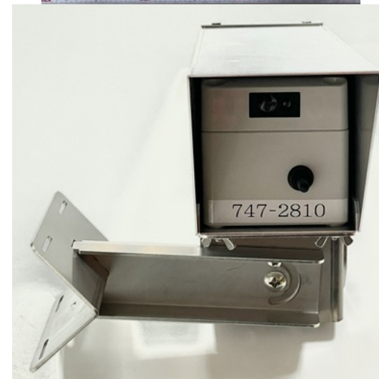
ブラケット付きの積雪深計IoTデバイス
