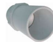
水位センサは、MaxBotix社の MB7093 や MB7386利用 (50cm～10mまで監視可能)
