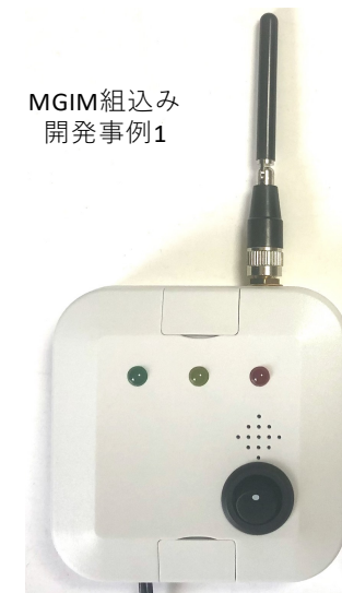
振動検知IoTデバイス (内部にMGIM搭載)
